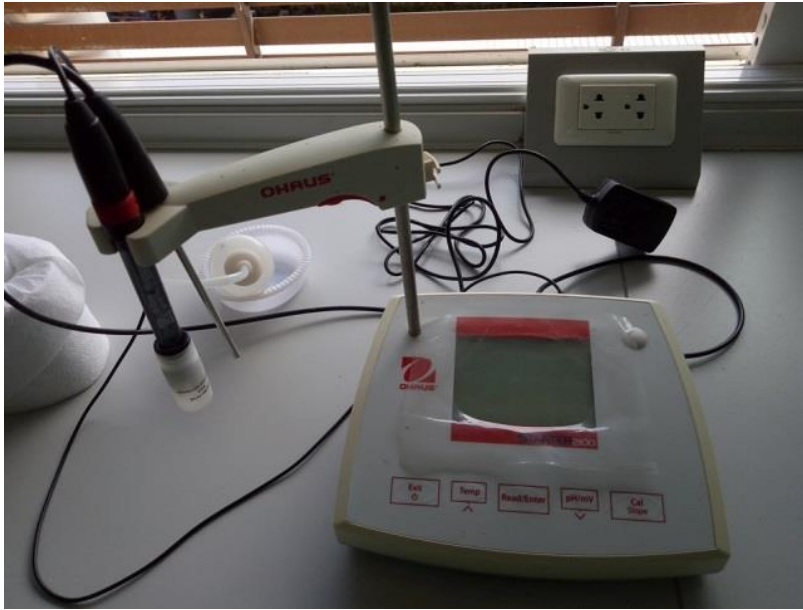
ภาพที่ 12 เครื่องวัดค่าความเป็นกรดเป็นด่าง
