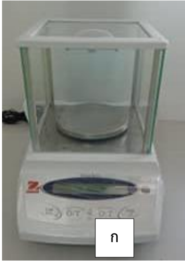
ภาพที่ 6 เครื่องชั่งแบบละเอียด (ก) และเครื่องชั่งแบบหยาบ (ข)
